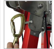
3-Pase el mosquetón en medio del guarda poleas y posicónelo correctamente sobre la polea.
