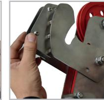
2-Mueva hacia abajo, el guarda polea hasta que la posición permita pasar el gancho del winche.
