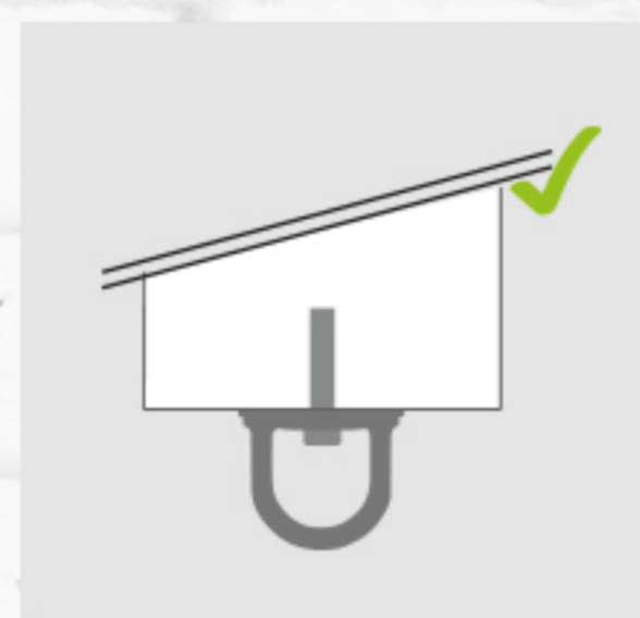
INSTALACIÓN SOBRE CABEZA CON UN PERNO
