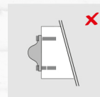
INSTALACIÓN CON MATERIALES NO COMPA- TIBLES
