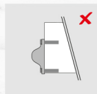
INSTALACIÓN DE ANCLAJE A BORDE DE PLACA
