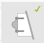
INSTALACIÓN CON DOBLE PERNO EN UNA UBICACIÓN CORRECTA
