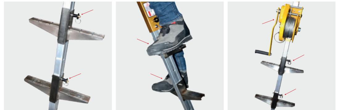
Recuerde que debe tener con el equipo (Trípode) dos escalerrillas con su correspondiente pin de seguridad, para hacer de una manera correcta el paso de WINCHE FUNCIONAMIENTO.
